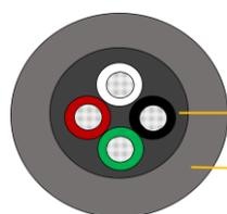
通常のケーブルを発泡被覆材で覆うことでケーブルに浮力を持たせています。
