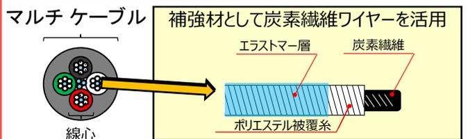
従来(自社製品)のケーブルに使われる線心と比べ**20倍**の耐屈曲性能(外部機関の試験値による)
