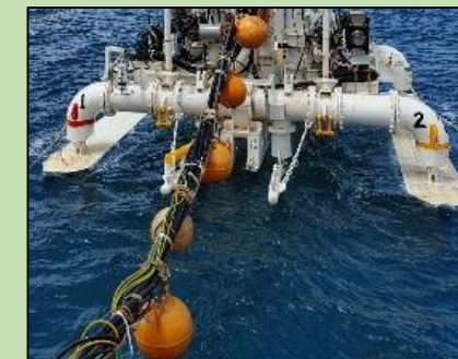
海底ケーブル埋設機
